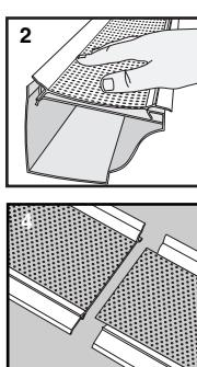
3 Continuer d'appuyer sur le protège gouttière, en créant un léger creux au centre. En même temps, appuyer sur le protège gouttière pour le clipser fermement au bord avant de la gouttière. Le protège gouttière devrait se fixer par simple pression au bord avant de la gouttière.
