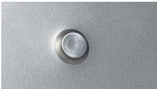
RESULTADO AL PONER UN REMACHE AUTOPERFORANTE
