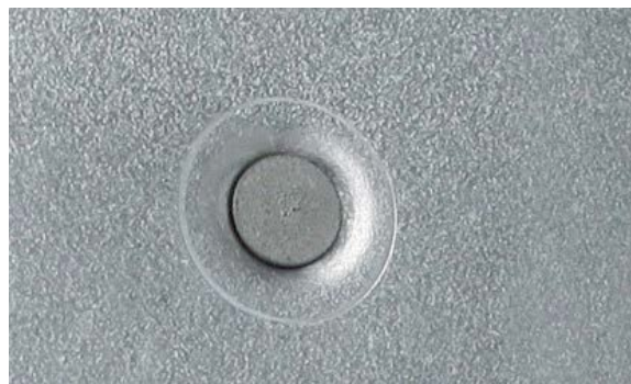
RESULTADO AL PONER UN REMACHE AUTOPERFORANTE
