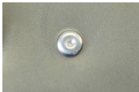
RESULTADO AL PONER UN REMACHE FLOW-FORM
