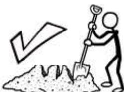
4. Comprobación del concreto: Golpee la superficie del concreto con una pala en la pila varias veces para hacer crestas
