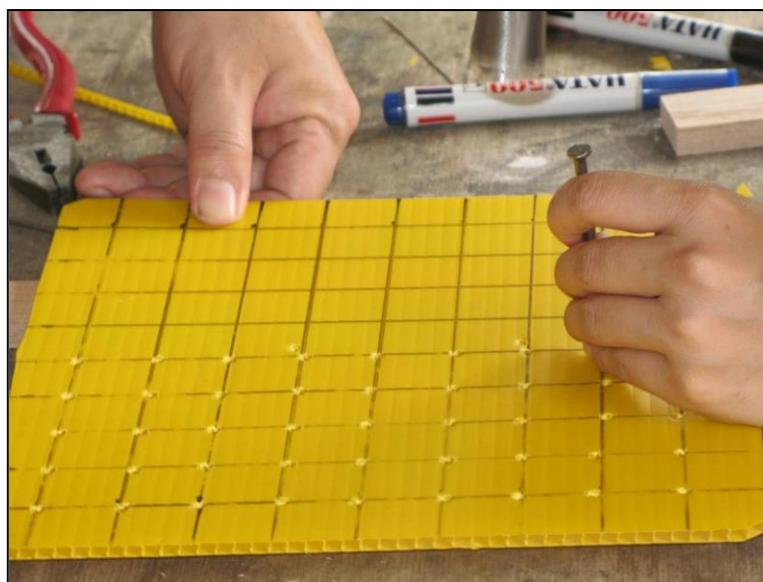
Placa de plástico ondulado con los agujeros perforados correctamente
