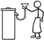
1. Ponga un extremo de la manguera sobre el tubo de salida. Ponga el embudo en el otro extremo de la manguera
