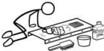
12. Limpie frotando lo que haya quedado de concreto del molde. Si el molde se guardara durante una temporada, eche aceite para que no se oxide. No eche aceite en la parte superior del interior del molde
