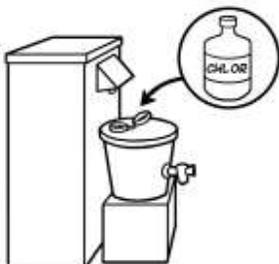
8. **Desinfecte el agua filtrada.** Pueden desinfectarla añadiendo gotas de cloro y pastilla de cloro, usando SODIS o hirviendo el agua filtrada.
