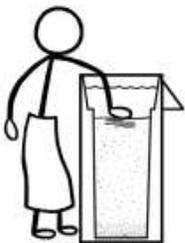
11. Cuando el agua sobre la arena tenga de profundidad entre 4 y 6cm , ustedes han añadido suficiente arena . Ahora tiene que limpiar la parte superior de la arena para que el filtro no se obstruya
