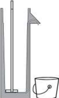
1. Ponga un palo dentro del filtro, tocando el fondo del filtro. Dibuje una línea en el palo donde llegue la parte superior del filtro
