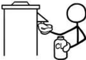
Es importante mantener limpio el tubo de salida. A veces el exterior del tubo puede ensuciarse. Esto hace que agua se ensucie otra vez. Ésta es la razón por la cual el agua debería ser desinfectada después de que sea filtrada.
