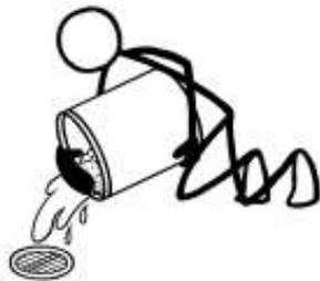
1. Ponga algo de arena de filtración tamizada en un balde. Esta arena tiene que pasar por un tamiz de 0.7 mm (0.03")
