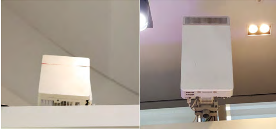
[그림 3-33] 좌: 화웨이(28GHz) FWA 안테나, 우: 3-5GHz 안테나
