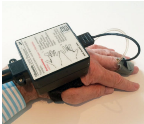
Abb. 6 Kontinuierliche (beat-to-beat) BD-Messung über eine Fingermanschette nach dem Peñáz-Verfahren.
