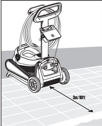
**5.1.1** Das Netzteil so positionieren, dass es sich etwa in der Mitte der Längsseite des Pools 3m/10 Fuß von ihm weg befindet.
