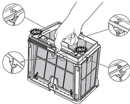
**6.2.5** Die Filterplatten in der folgenden Reihenfolge montieren: Platte 4 → 3 → 2 → 1.
