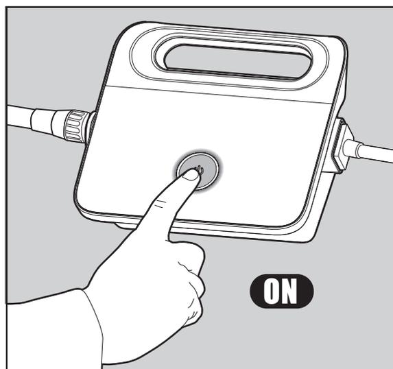
**5.2.2** Schalten Sie den Strom EIN. Der Poolreiniger ist nun in Betrieb, bis er das Ende des Reinigungszyklus erreicht hat.
