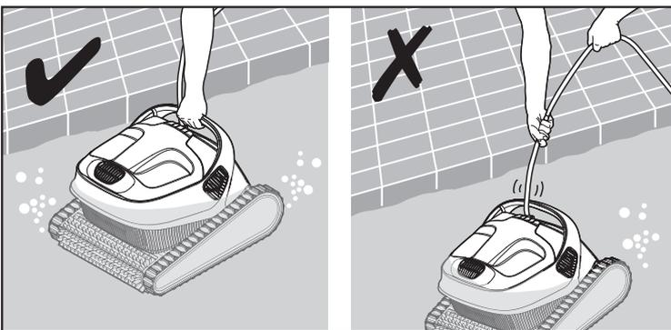
5.4.2 Den Poolreiniger am Schwimmkabel an den Beckenrand ziehen. Den Poolreiniger mithilfe des Griffs aus dem Pool heben.
