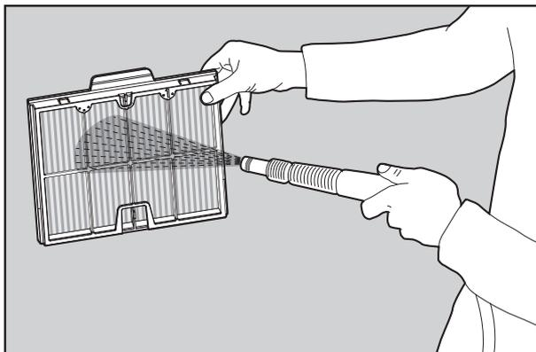
**6.2.4** Den Filter mit einem Schlauch reinigen.
