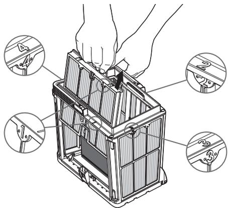
**6.2.3** Die Platten in der folgenden Reihenfolge demontieren: 2 → 3 → 4.
