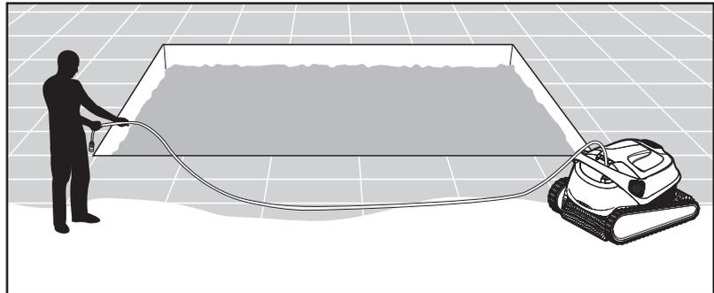
**5.1.2** Kabel abrollen und so ausziehen, dass es keine Knicke aufweist.
