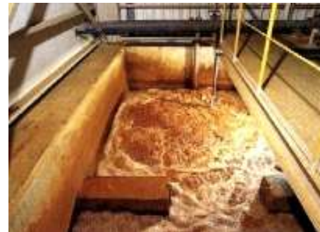
1. 酸化槽での細菌による二価鉄の酸化
