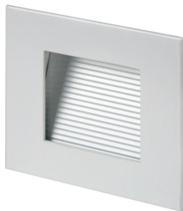
Luminária balizadora para embutimento em planos verticais, dotada de LED com 100 lumens e emissão assimétrica. LEDs com cor de emissão em Âmbar, Branco 2700K e Branco 5000K. Índice de proteção IP 64 (ambientes internos e externos). Alimentação com driver Bivolt (127V/220V) incorporado na luminária. Disponível em alumínio com pintura eletrostática em Branco, Corten, Prata e Preto. Consumo de 3W. Alojamento para embutimento em alvenaria incluso.
