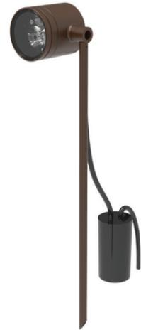
Versátil projetor orientável disponível para áreas externas (IP 65) com versões de SOBREPOR, ESPETO e ABRAÇADEIRA para árvores e pilares. Fluxo, consumo, controle de fecho e alimentação conforme a versão desejada. LEDs com cor de emissão em Âmbar, Branco 2700K e Branco 5000K. Disponível com corpo em alumínio com pintura eletrostática em Branco, Corten, Prata e Preto.
