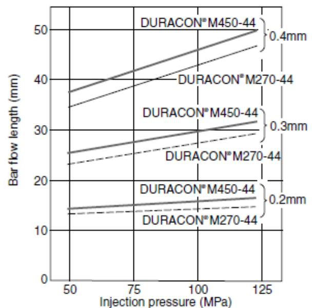
Processing parameters Material temp. : 185~190°C
