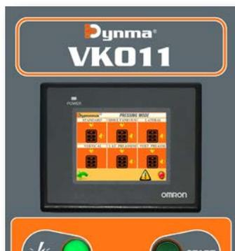
**VK011 STANDARD** equipada con pantalla táctil de programación para la monitorización y selección de todos los parámetros funcionales, fuerzas de prensado, tipo de maniobras, alarmas y otros.
