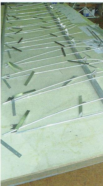
Montage à blanc en disposant tous les éléments de l'aile. Même si toute la boulonnerie possède des écrous nylstop, une petite goutte de loctite est bienvenue. Une fois entoillée, rien ne doit bouger !
