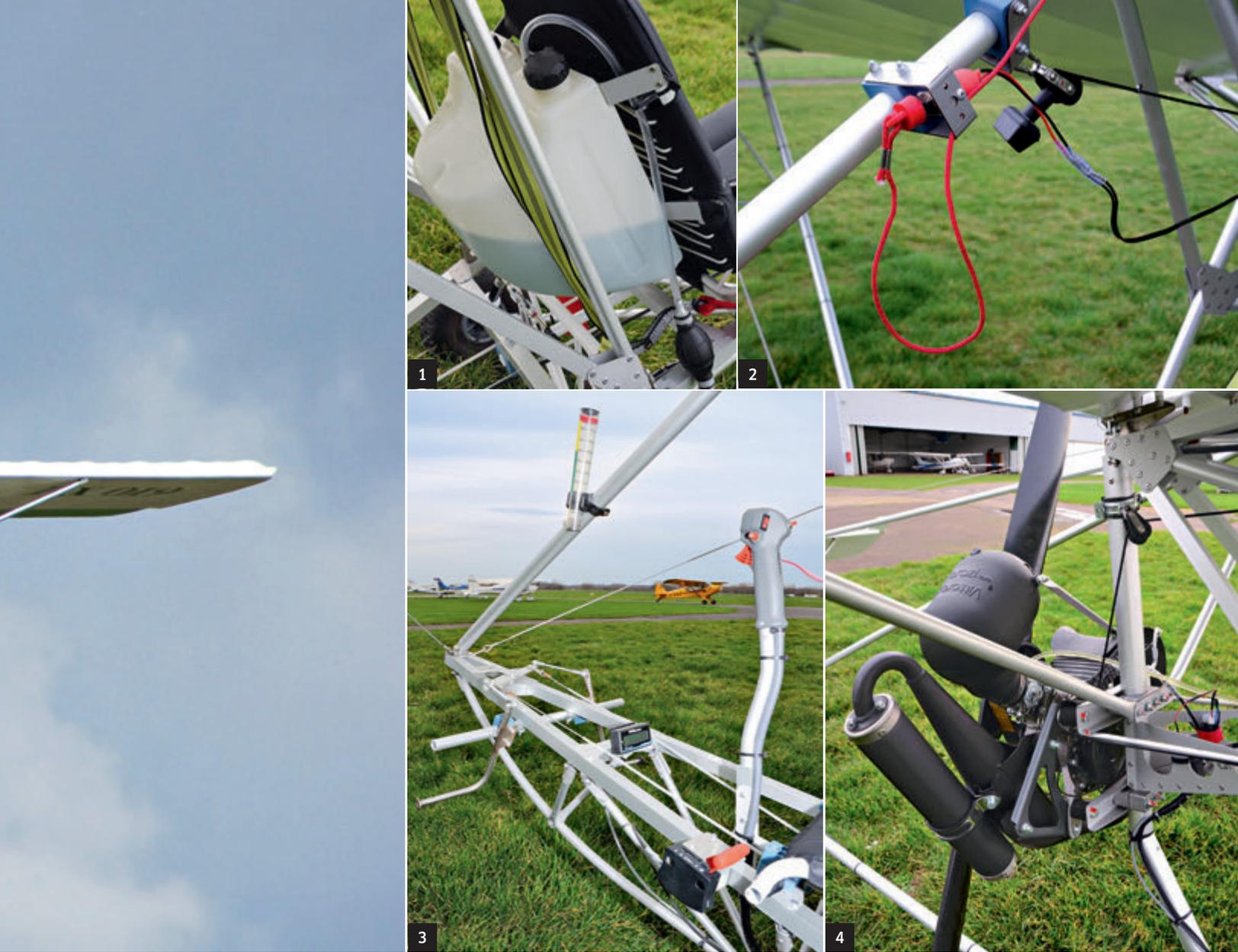
zeigt ein simples Staurohr an, das PPGmeter liefert weitere Daten – sofern man das winzige Kombiinstrument zwischen den Beinen nicht übersieht. Eigentlich fehlt mehr, als es gibt: Benzinhahn, Zündschloss, Bremsen, Landeklappen, Trimmung, Sicherungen, Bordnetz, Gepäckraum ... Frag nicht, was dein Fluggerät für dich tun kann, sondern worauf du verzichten kannst.
