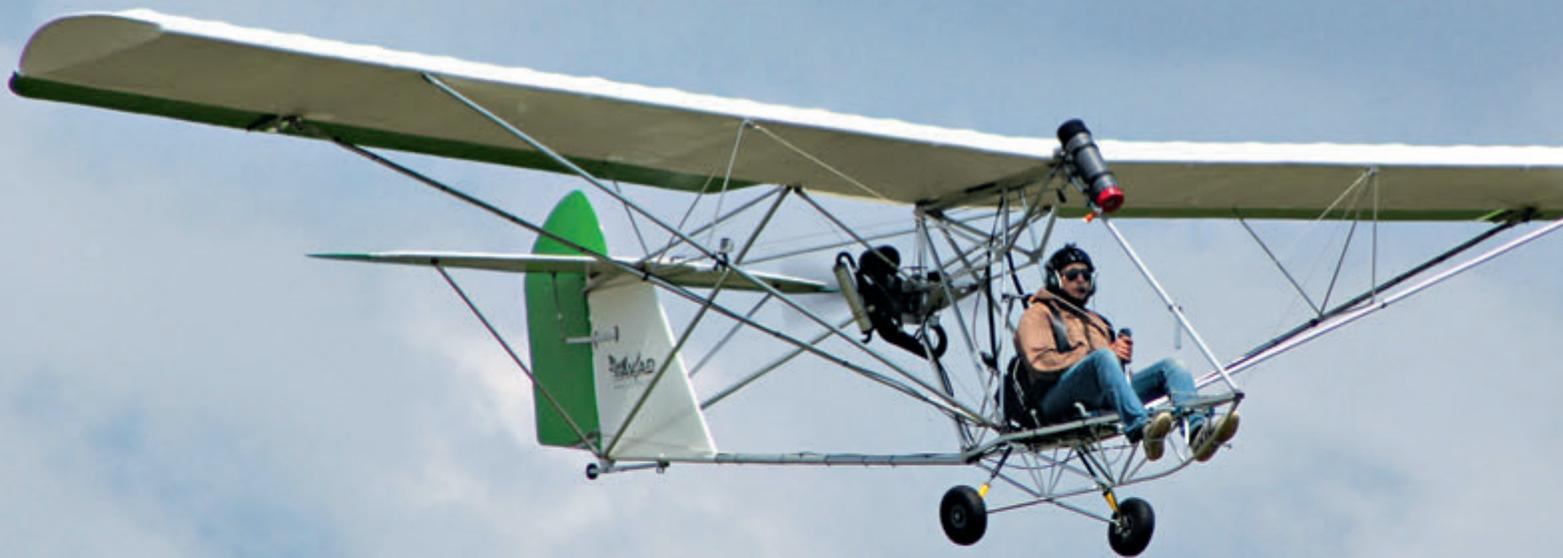
**Cruisen oder segeln:** Der Motor kann auch bloß als Aufstiegshilfe eingesetzt werden. Im Segelflug beträgt die Gleitzahl 10 bis 11
