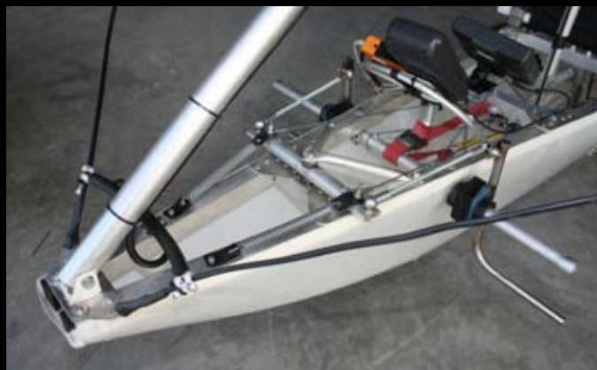
Sulla barra della pedaliera sono state applicate due molle per facilitare la centralizzazione
