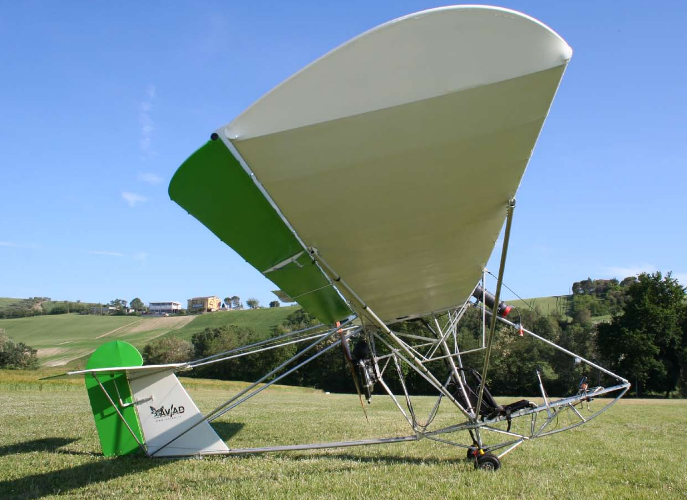
Il nuovo carrello biciclo che sostituisce il monoruota ha semplificato le operazioni a terra
