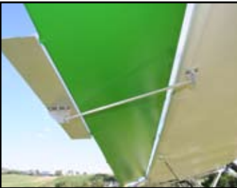
I compensatori per alleggerire l'azionamento dei lunghi alettoni
