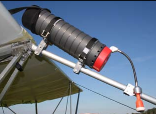
Comelli ha messo a punto per l'Aviad un paracadute di emergenza ad aria compressa fissato sul montante anteriore
