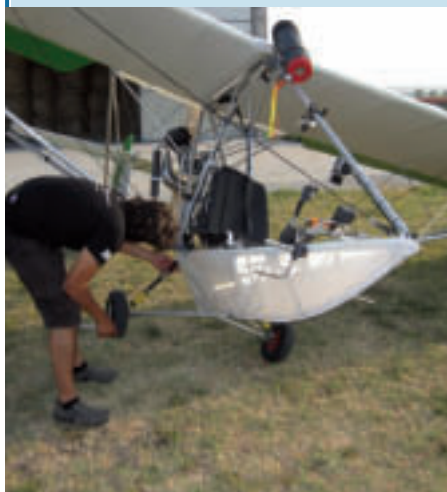
Vorflugcheck – Kontrolle des Hauptfahrwerks samt Räder: einfach die Maschine hochheben!
