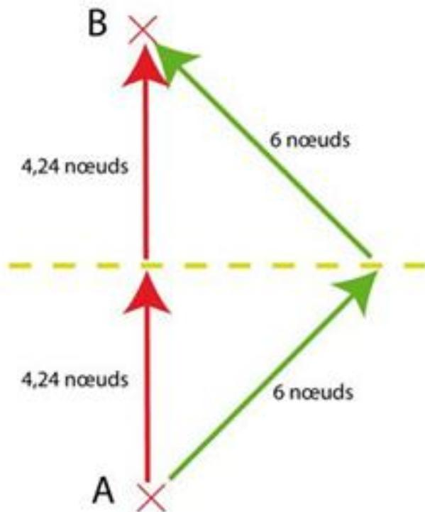
Prenons l'exemple d'un voilier qui remonte à 45° du vent et qui avance à 6 nœuds. Il va du point A au point B.
