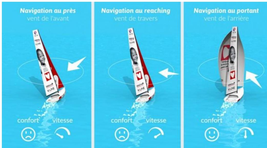
Lorsque le voilier est face au vent, il ne peut pas avancer ; on dit alors que le voilier est vent debout (dit aussi bout au vent). Il doit s'écarter d'environ 45° de l'axe du vent pour pouvoir progresser à l'aide de ses voiles (30° sur les voiliers de régates les plus performants).
