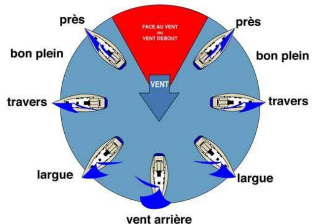
L'allure dépend de l'angle formé entre l'axe principal du navire (axe proue-poupe) et le lit du vent apparent.
