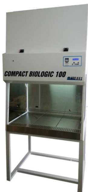
Este equipamento permite trabalhar com segurança, pois sua área de trabalho é projetada conforme (ABNT NBR 13700) e ISO CLASSE 5 e norma internacional ISO 14.644-1, NSF49, procedimentos contidos na norma 209E Federal Standard, Classe II Tipo A1. Equipado com dois filtros HEPA, um para recirculação e outro para renovação do ar.
