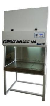
Este equipamento permite trabalhar com segurança, pois sua área de trabalho é projetada conforme (ABNT NBR 13700) e ISO CLASSE 5 e norma internacional ISO 14.644-1, NSF49, procedimentos contidos na norma 209E Federal Standard, Classe II Tipo A2. Equipado com dois filtros HEPA, um para recirculação e outro para renovação do ar.
