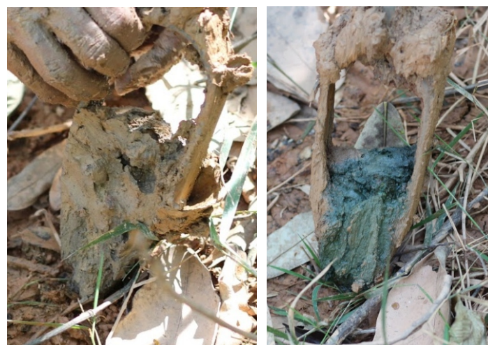
Figura 18 - Identificação de solo hidromórfico com a utilização do reagente ferricianeto de potássio ( C_6N_6FeK_3 ).
