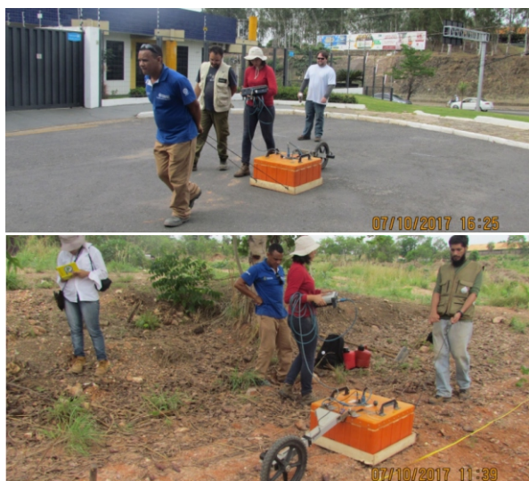
Figura 13 - Exemplo da aplicação do método eletromagnético em áreas aterradas no município de Cuiabá-MT.
