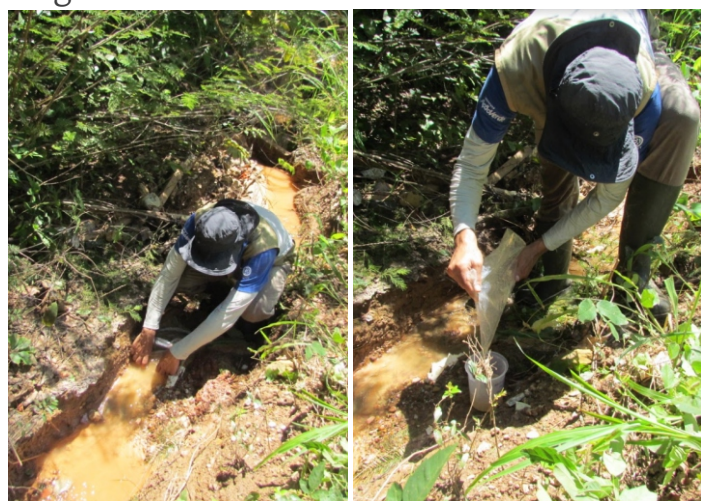
Figura 24 - Procedimento de medição de vazão utilizando uma sacola plástica para a coleta da água de uma seção do canal formado por uma nascente.
