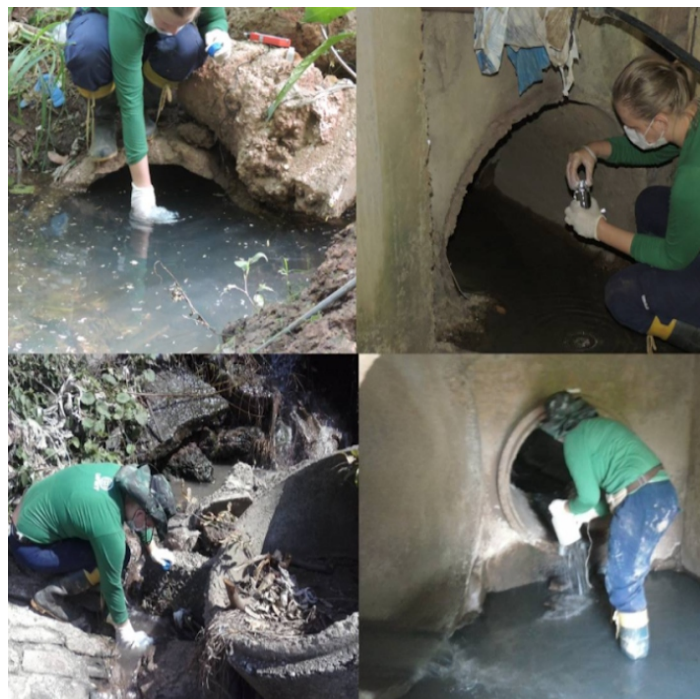
Figura 43 - Coleta de amostra de água de nascentes da área urbana de Cuiabá para caracterização de parâmetros físicos, químicos e microbiológicos da água.
