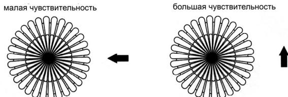
При выборе места установки необходимо исключить из зоны обнаружения датчика объекты, которые могут приводить к его ошибочным срабатываниям. Для этого необходимо избегать установки датчика вблизи зон температурного возмущения (кондиционер, центральное отопление) и вентиляторов. Чем ближе температура окружающей среды к 36 °C, тем хуже чувствительность прибора. Туман или дождь могут существенно повлиять на область обнаружения датчика. Верхняя одежда так же влияет на чувствительность датчика.
