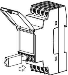
3. Démarrer l'application et sélectionner l'option "connecter un appareil" pour lire les données (configuration) de l'horloge.
