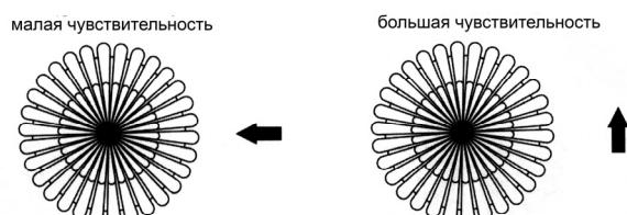
При выборе места установки необходимо исключить из зоны обнаружения датчика объекты, которые могут приводить к его ошибочным срабатываниям. Для этого необходимо избегать установки датчика вблизи зон температурного возмущения (кондиционер, центральное отопление) и вентиляторов. Чем ближе температура окружающей среды к 36 °C, тем хуже чувствительность прибора. Туман или дождь могут существенно повлиять на область обнаружения датчика. Верхняя одежда также влияет на чувствительность датчика.
