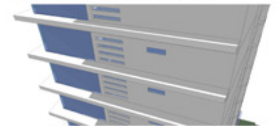
ALEROS EXTENDIDOS PARA PROTECCIÓN DE VENTANAS
