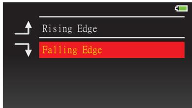
Select Waveform Trigger: Rising Edge or Falling Edge
