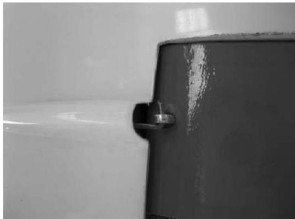
Das Anlenkgestänge im Servohebel einhängen, ebenso mit der Z-Abkröpfung im Ruderhorn. Bei Servo in Mittelstellung montiertem Seitenruder und eingestecktem Ruderhorn die richtige Länge des Gestänges überprüfen. Unter Zugabe von Klebstoff wird jetzt das Ruderhorn in das Seitenruder geklebt.
