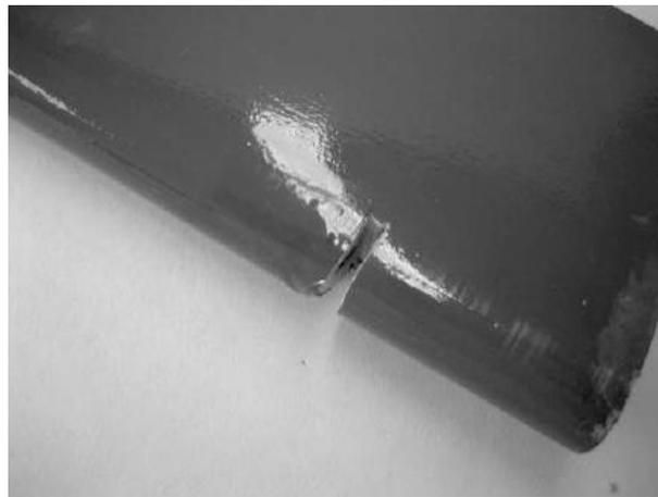
Die Mitte der beiden Aufnahmeschlitzte auf den Seitenflossenabschluss übertragen und mit  $\varnothing 3,5$  Löcher in den Abschluss bohren. Die beiden Aluminiumlager in den Abschluss eindrehen bis die beiden Lagerbohrungen ca. 2mm hinter der Seitenflossenendkante sind, gemessen von Bohrungsmittle bis Endkante.
