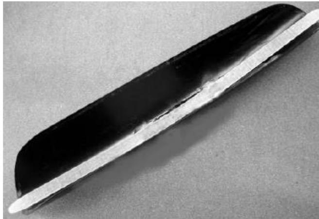
Je länger die Verklebung der Zunge mit der Kabinenabdeckung gewählt wird, desto fester sitzt die Abdeckung auf dem Rumpf.
