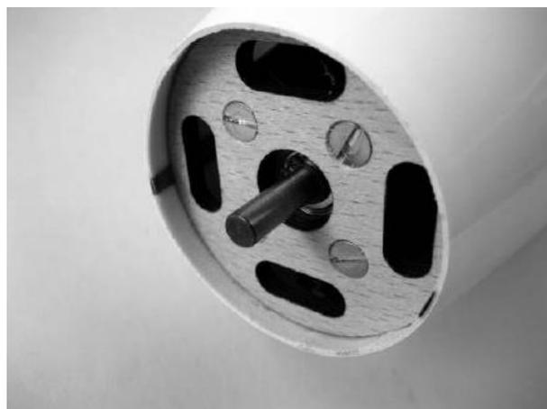
Durch das Aufschieben des Spinners die Passgenauigkeit, Spinner/Rumpf, überprüfen, evtl. ist etwas Nacharbeit notwendig.
