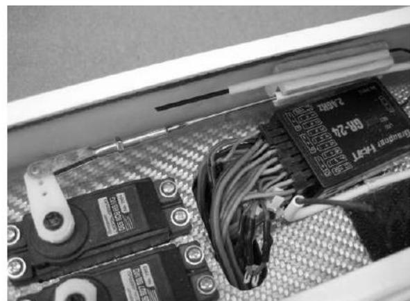
Das Brettchen zum Befestigen des EIN/AUS Schalters, Empfängers und Empfängerakkus wird mittels der zwei Nutleisten im Rumpf befestigt. Die Nutleisten werden rechts und links im Bereich der Anschlussrippen an die Rumpfseitenwände geklebt, so dass das Brettchen von vorne eingeschoben werden kann. Gesichert wird das Brettchen durch Eindrehen von zwei Zylinderkopfblechschauben.
