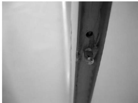
Jetzt kontrollieren, dass das Seitenruder den angegebenen Ausschlag nach rechts und links ausführen kann, indem das Seitenruder mittels Lagerdraht montiert wird. Das Seitenruder wieder abziehen und die beiden Lager mittels Klebstoff sichern.
