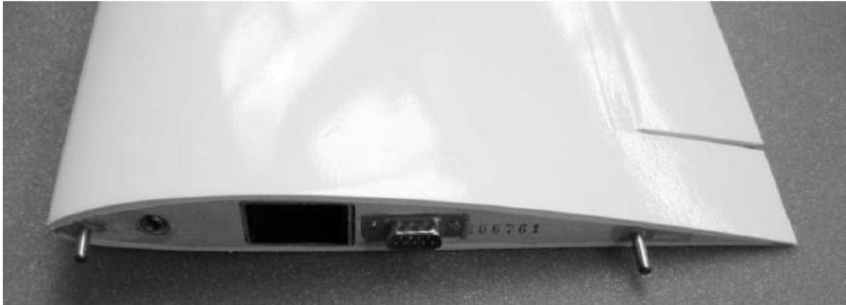
Vor dem Einkleben der Verdrehstifte müssen diese an den Klebstellen angeschliffen werden. Beim Einkleben sollten sie ca. 15 mm aus den Wurzelrippen herausstehen. Wie auf dem Foto zu sehen, können die Servoanschlusskabel mittel einem G 6 Stecker zusammengefasst werden.
