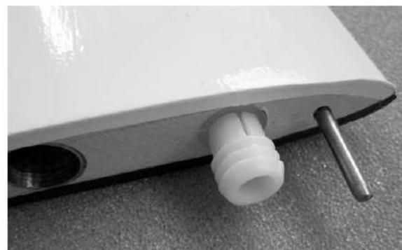
Zum Sichern der Außenflügel am Innenflügel werden Kunststoffversicherungen in die entsprechenden Bohrungen eingeklebt.
