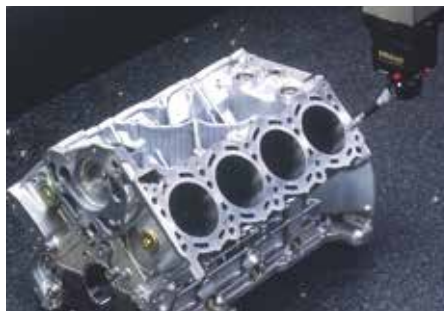
▲ Ejemplo de montaje de palpador de activación por contacto
