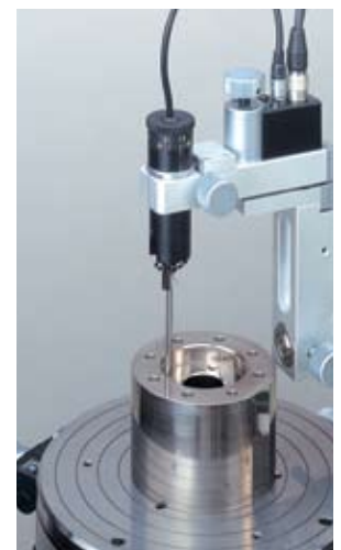
Medición dentro de diámetro interior
