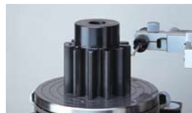
Medición en pieza con discontinuidades
