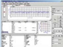
SURFPAK-SV Pantalla de medición de rugosidad superficial y resultados mostrados
