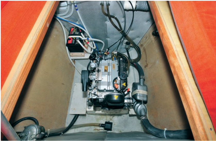
Les moteurs sont implantés sous les couchettes arrière et très avancés dans le bateau : meilleure accessibilité, protection radicale contre la corrosion et centrage des poids pertinent.
