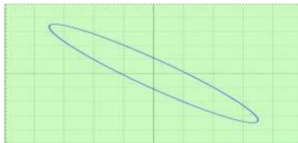
12. Se tienen dos señales senoidales, en la primera la amplitud corresponde al último dígito de su cedula de identidad y se representa en el eje X; en la segunda, la amplitud corresponde al penúltimo dígito de su cedula de identidad y se representa en el eje Y. Determine las expresiones analíticas de dichas señales (Si alguno de los dígitos es cero, asuma el numero 23 como numero terminal de su cedula de identidad).
