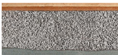
Plafond massif avec dalle en fibre de bois
