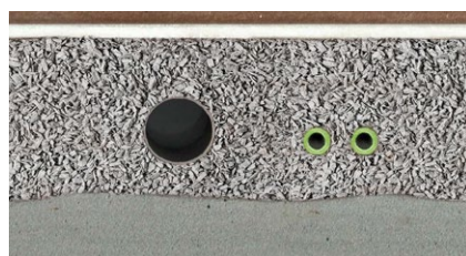
Plafond massif avec assemblage à sec
