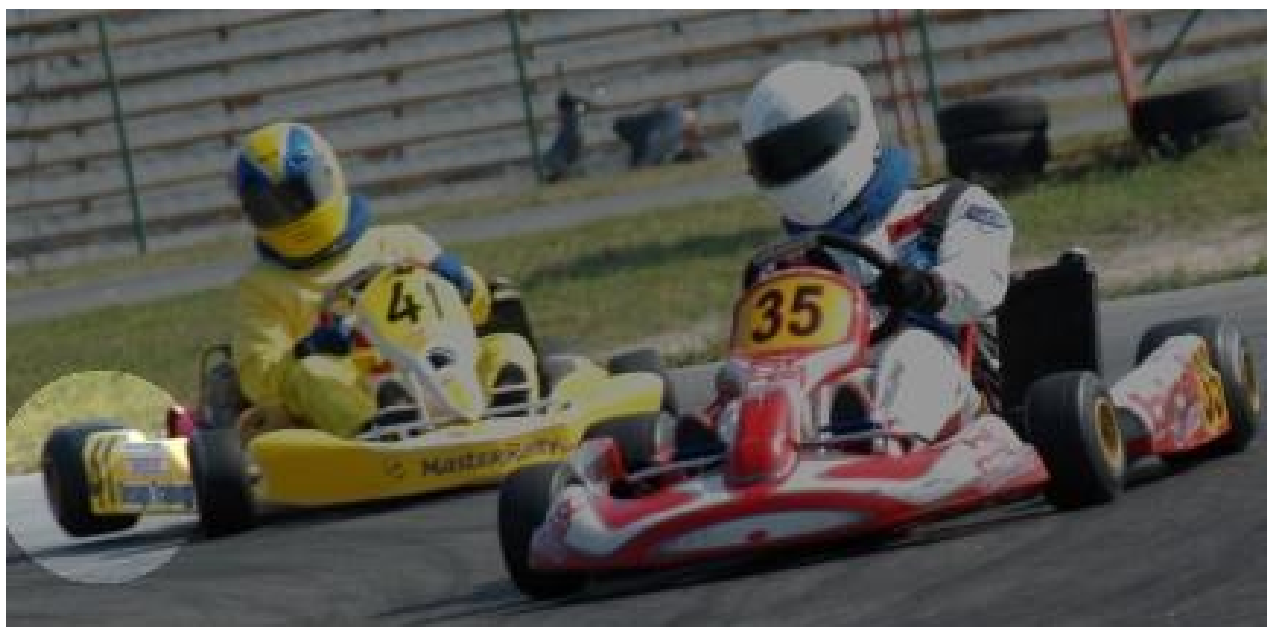
Полное вывешивание заднего внутреннего колеса кarta в повороте
