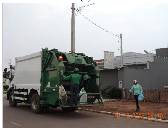
Figura 11. Caminhão compactador de 15 m 3 (A) e garis realizando a coleta dos RSDC (B)
