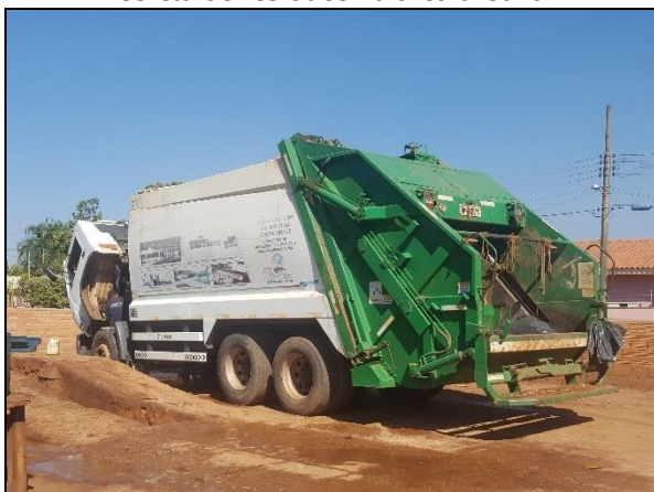
Figura 5. Caminhão compactador utilizado na coleta de resíduos na área urbana
