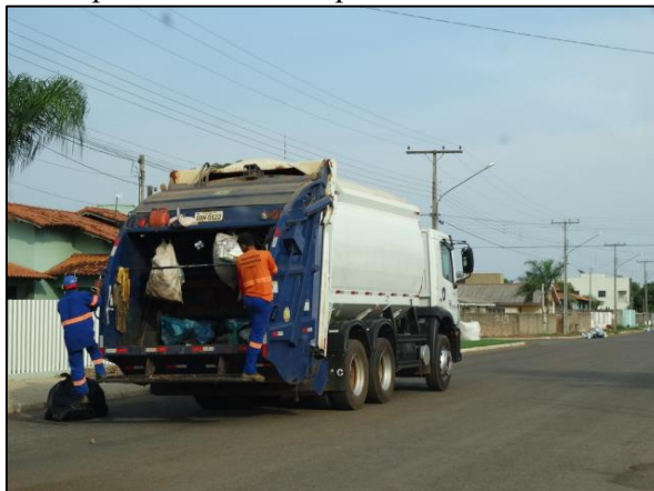
Figura 10. Caminhão compactador utilizado para coletar os resíduos sólidos do município
