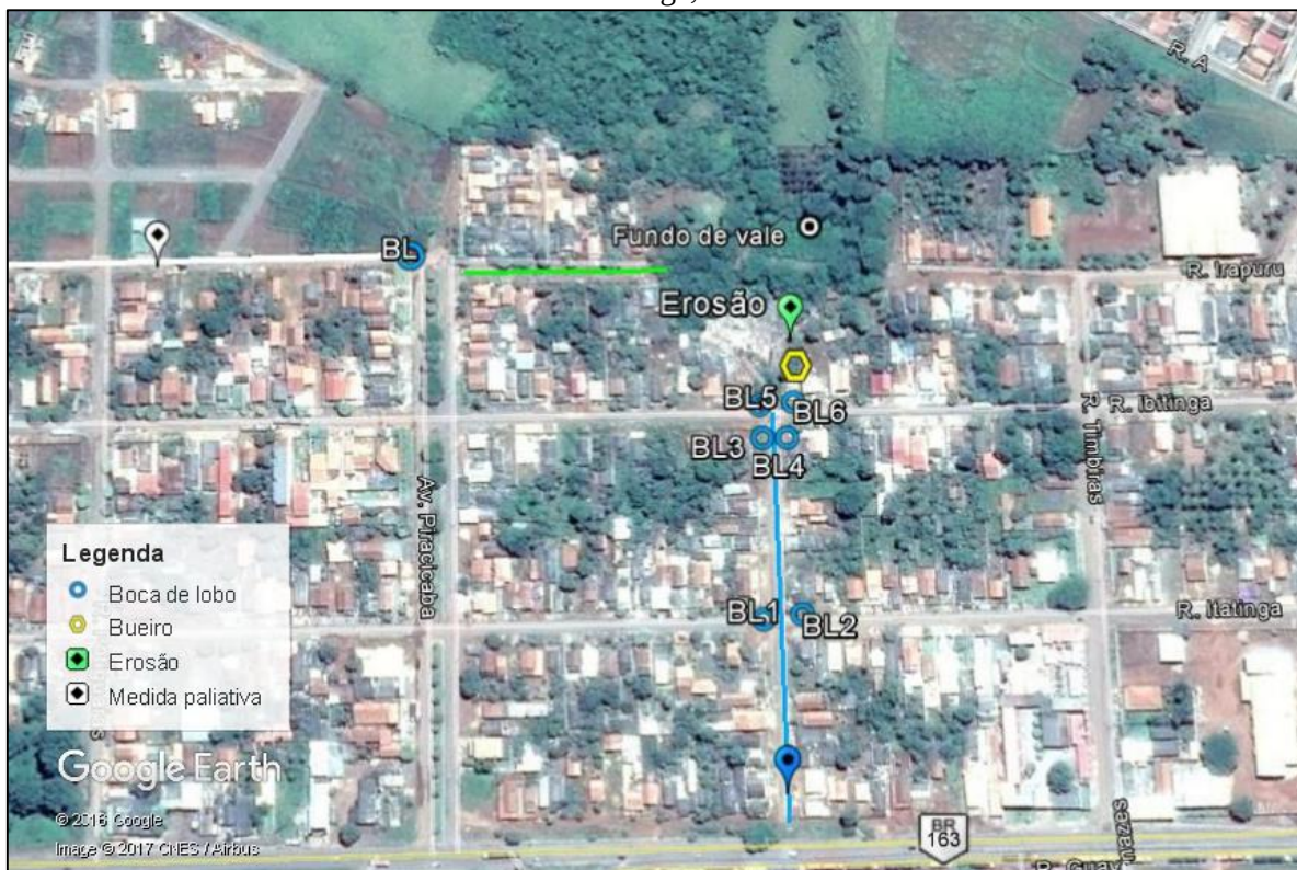
Figura 9. Localização dos dispositivos de drenagem da Rua Guaranis situados a montante da erosão na Rua Ibitinga, em Jaciara
