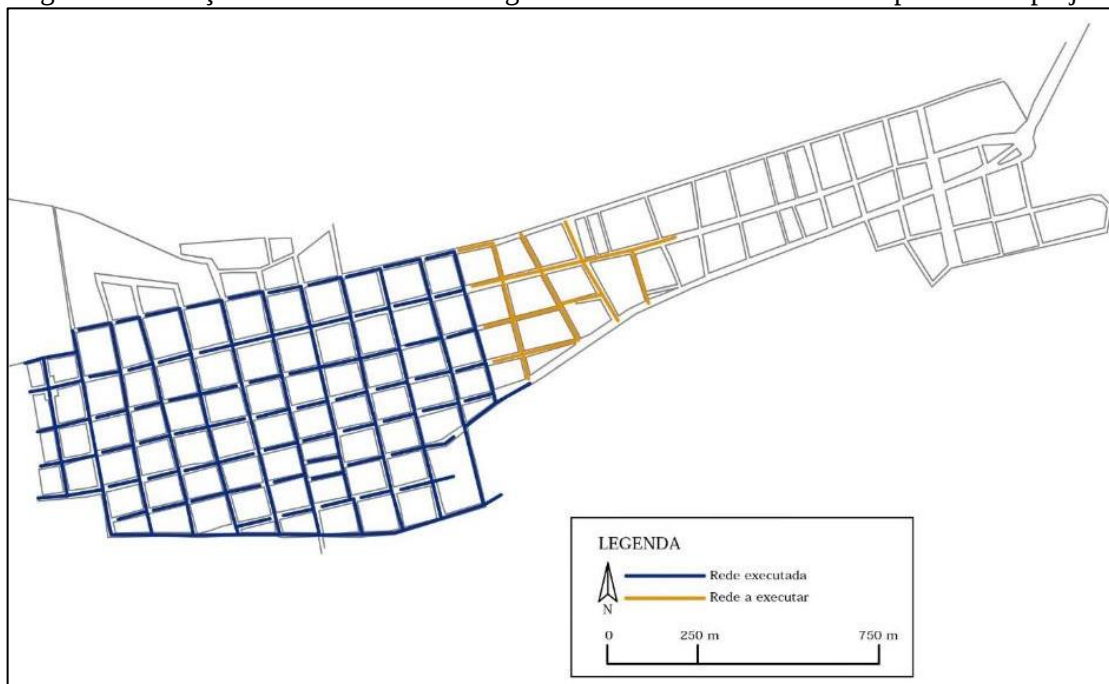
Figura 5. Indicação da rede coletora de esgoto executada e rede a executar prevista no projeto
