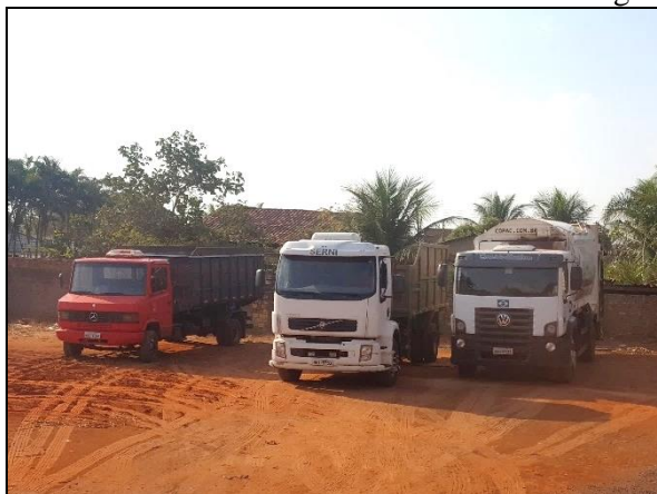
Figura 19. Caminhões caçambas com capacidade para 25 m 3 e 18 m 3 , e caminhão compactador de 15 m 3 , utilizados na coleta de resíduos na cidade de Água Boa
