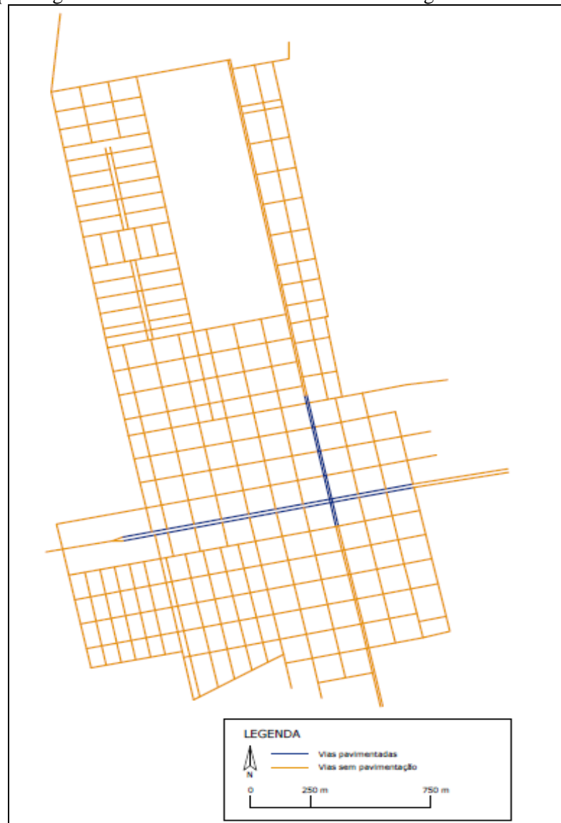
Figura 9. Esquema gráfico da malha viária urbana e microdrenagem de Bom Jesus do Araguaia
