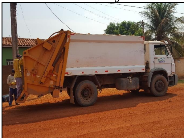
Figura 5. Caminhão compactador de 12m 3 utilizado na coleta de resíduos na área urbana de São Félix do Araguaia
