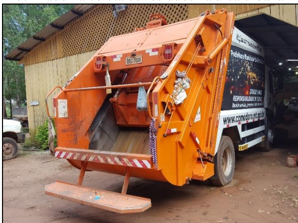
Figura 15. Caminhão compactador de 15 m 3 utilizado na coleta de resíduos na área urbana
