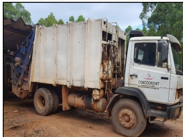
Figura 16. Caminhão compactador de 10 m 3 utilizado na coleta de resíduos na área urbana
