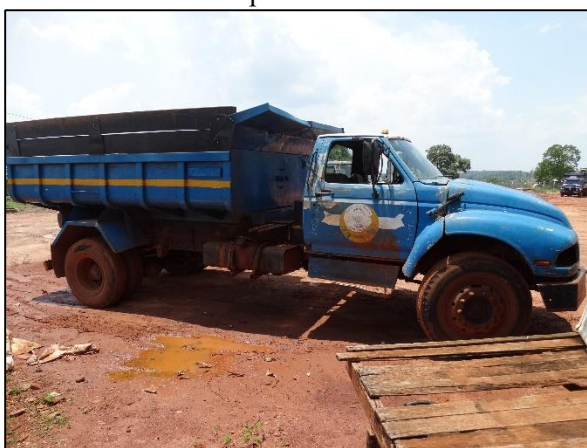
Figura 4. Caminhão basculante para a coleta de RSDC em Santo Afonso
