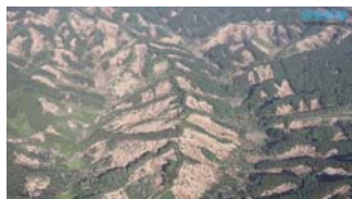
火山灰で被覆された山地での地震による斜面崩壊と崩土の流出(2018年9月6日厚真町)
